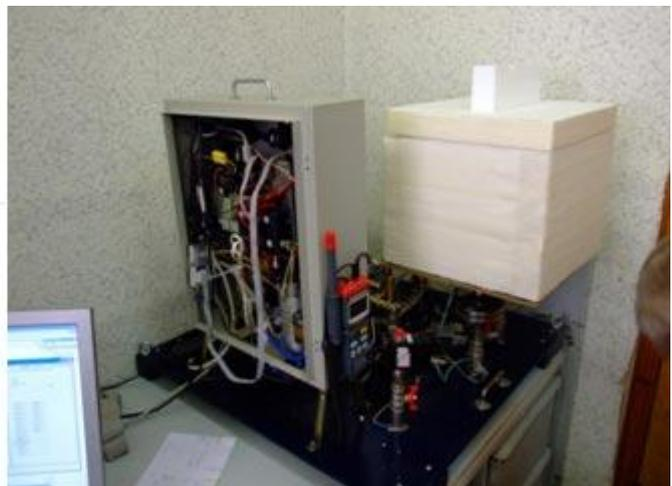
1. Преобразователь Давления Прецизионный (ПДП) со шкафом управления – по одному на каждый резервуар. В некоторых случаях работы с небольшими резервуарами, возможна поставка ПДП со специальным коммутатором измеряемого давления – по одному на группу резервуаров.
