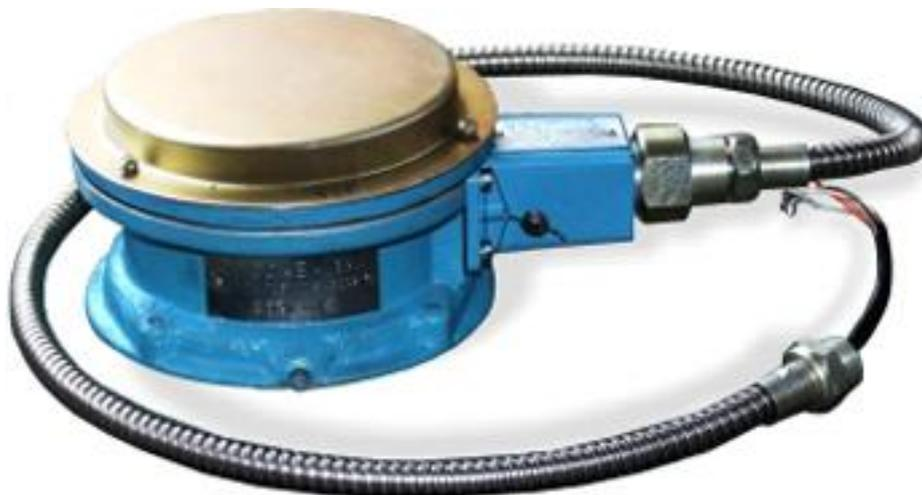
Устройство съема сигнала типа УСС предназначено для преобразования величины угла поворота вала в электрические импульсы с последующей передачей их по линии связи. Может устанавливаться на счетчики типа ПЖ, ППО и ППВ. Работает совместно с вторичным прибором ВП-5 или с контроллером типа КУП с электронным цифровым отсчетным указателем разового и суммарного учета. Длина линии связи до 1500м.
