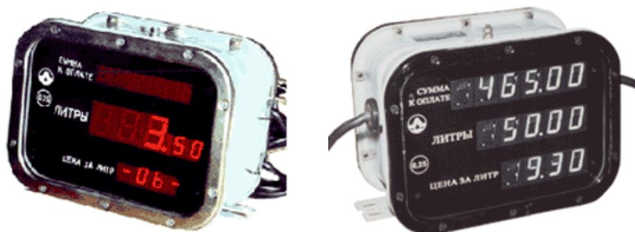
Контроллеры КУП-1 предназначены для управления колонками Ливенка 22201. Отпуск топлива может производиться по двум постам одновременно. Габаритные размеры - 305x213x157мм.
