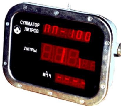
Контроллеры КУП-30, КУП-31 предназначены для работы в составе счетчиков ППТ, ППО или ППВ и служат индикатором разового, суммарного и мгновенного расхода жидкости проходящей через счетчик.
