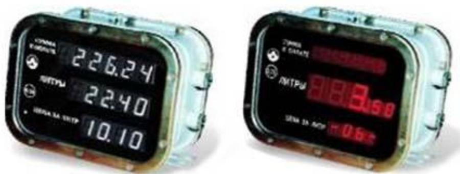
Контроллер КУП - интерфейсное отсчетное устройство, предназначено для управления топливораздаточными и газонаполнительными колонками. На индикаторах контроллера отображаются значения суммарного и разового количества дозы, цены, номера поста, состоянии, в котором находится ТРК.
