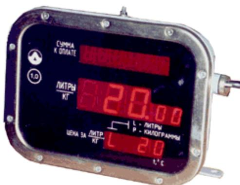
Контроллеры КУП-20 (КУП-21) предназначены для управления газонаполнительными колонками - КГН или установками для измерения количества сжиженного газа - УИЖГЭ-20М. Отпуск СУГ может производиться как в килограммах, так и в литрах - приведенных к 15°C, в зависимости от введенного значения процентного содержания пропана. Габаритные размеры - 305x213x85.
