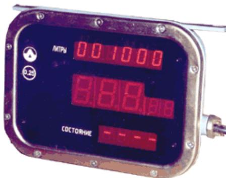
Контроллеры КУП-40 (КУП-42, КУП-43) предназначены для управления и отображения процесса дозированного отпуска топлива потребителем через установки типа АСН (автоматизированные системы налива).
