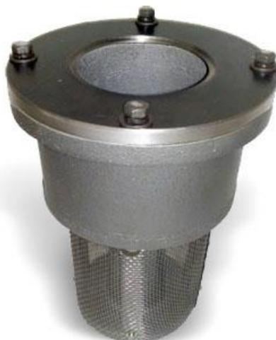
Клапан предназначен для перекрытия трубопровода с целью исключения движения нефтепродукта в обратном направлении в момент остановки насосных или иных перекачивающих устройств и устанавливается на всасывающем трубопроводе в резервуаре.
