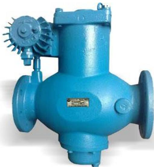
Клапан-отсекатель КО предназначен для ступенчатого регулирования расхода и открытия (закрытия) проходного сечения трубопровода с целью обеспечения безопасной технологии налива автомобильных или железнодорожных цистерн неагрессивными нефтепродуктами вязкостью от 0,55 до 60 мм<sup>2</sup>/с с рабочим давлением до 0,6 МПа.
