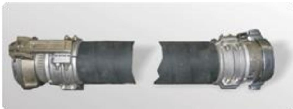
Предлагаем быстроразъёмные соединения с условным проходом 50, 80, 100 мм (Ду-50, Ду-80, Ду-100) предназначенных для быстрого герметичного соединения гибких трубопроводов друг с другом. Так же предлагаем Вам рукава Ду-50, Ду-80, Ду-100 оснащенные быстроразъёмными соединениями предназначены для слива (налива) нефтепродуктов из автоцистерн или отвода паров нефтепродуктов, а так же в пищевой промышленности.
